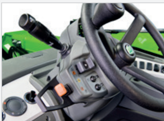
HM: pulsanti inversore Dual-Shuttle
