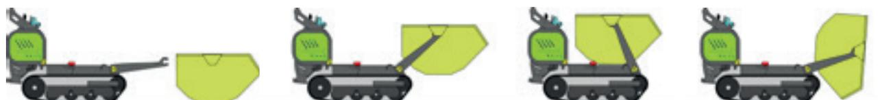
Il dispositivo brevettato per l'aggancio rapido delle attrezzature, che equipaggia il carro con due forti braccia meccaniche, è la base tecnologica del Cingo Multifunzione. Gran parte delle attrezzature del sistema Multifunzione sono compatibili con questo dispositivo.
